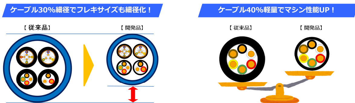
図 開発したロボット用ケーブルと従来品の比較概念図
